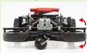
Le plateau de coupe flottant est suspendu au châssis. Ceci permet aux lames de suivre le contour de la pelouse, tout en protégeant le gazon et en assurant une coupe parfaitement uniforme.
