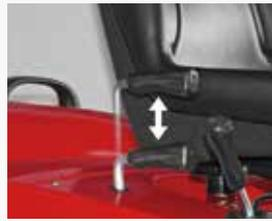
Trappe anti-bourrage patanté à ouvrir depuis le siège conducteur pendant la tonte
