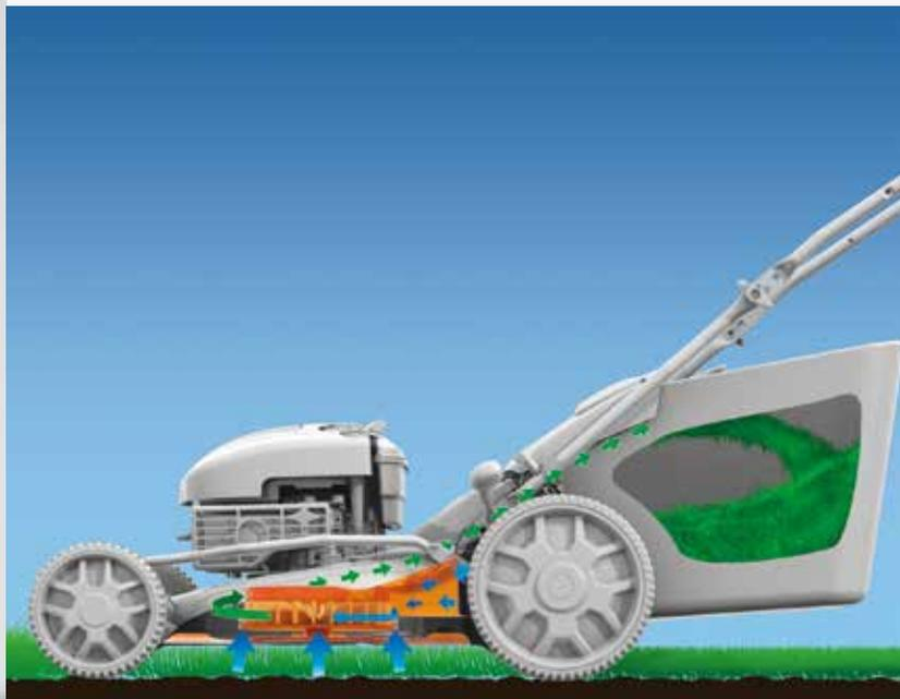
Un grand ventilateur sous le couteau harmonise parfaitement avec le système de coupe. Il provoque un flux d'air beaucoup plus important entre le couteau et le sac récolteur qu'une tondeuse conventionnelle. Ce qui nous garantit un ramassage impeccable même en cas d'herbe haute et mouillée. **(sout tondeuse 42cm largeur de coupe)**
