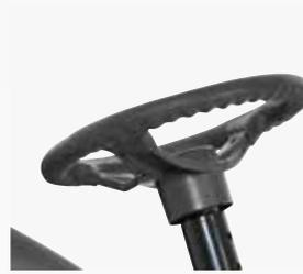
Volant souple avec arbre télescopique réglable
